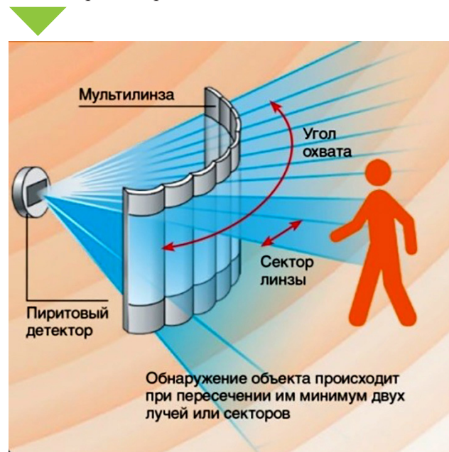
Рис. 3. Принцип работы датчика движения
